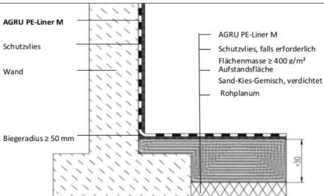
Dichtungsbahn "AGRU-PE-Liner M - Auffangwanne" als Abdichtungsmittel von Auffangwannen und Auffangräumen zum Lagern von wassergefährdenden Stoffen
