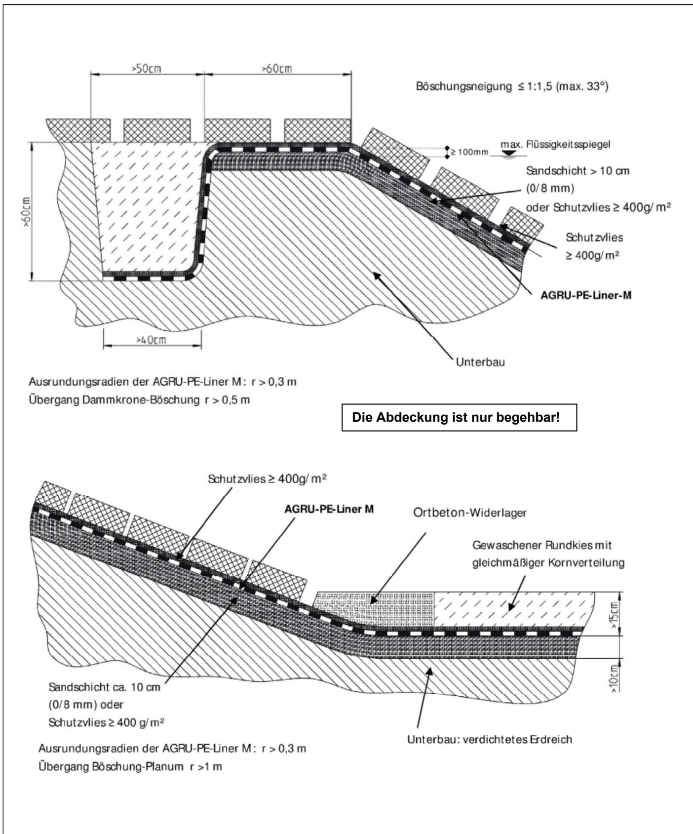
Dichtungsbahn "AGRU-PE-Liner M - Auffangwanne" als Abdichtungsmittel von Auffangwannen und Auffangräumen zum Lagern von wassergefährdenden Stoffen
