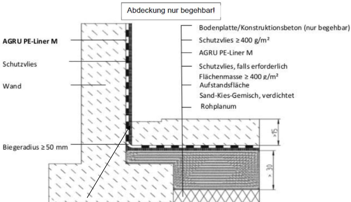
Anschlüsse bzw. Fugen sind mit geeignetem Material zu verschließen, damit austretende wassergefährdende Stoffe schnell und zuverlässig auf der Schutzabdeckung erkannt werden können.
